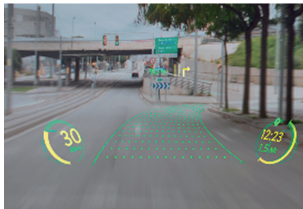
図表14 米 Harman の自動車フロントガラス向け AR ヘッドアップディスプレイ
